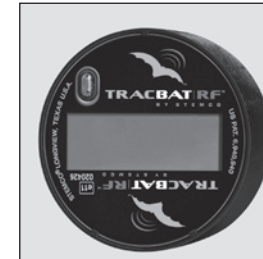
A fin de ahorrar energía, la pantalla se apaga cuando se detecta vibración (vehículo en movimiento).
