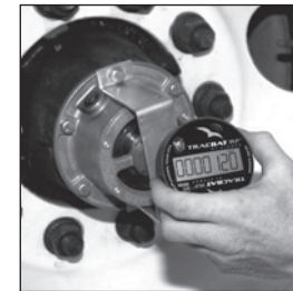
Instale la unidad TracBAT PRO antes de que el temporizador llegue a cero para evitar conteos inducidos por la manipulación.
